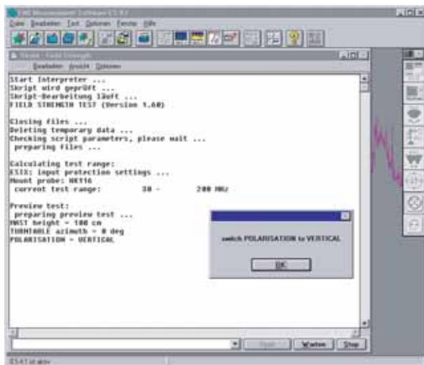
Weiterhin können Messergebnisse kombiniert, Breitbandstörer nach MIL in einer bandbreitenbezogenen Anzeige (/1 MHz) ausgegeben und z.B. bei Freifeldmessungen bekannte Umgebungsstörungen über eine Frequenzliste ausgeblendet werden.
